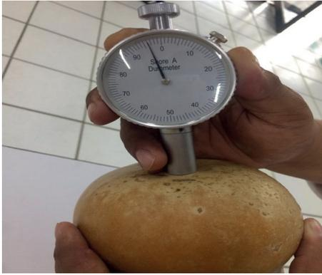
Figura 4. Muestra la prueba de dureza con el durómetro.
