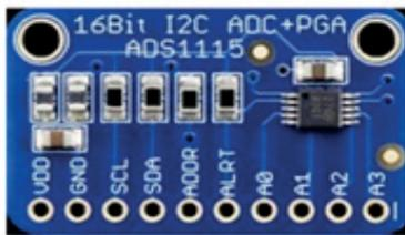
Figura 2. Convertidor analógico/ digital ADS1115. Nota: Djatmiko et al. (2017).
