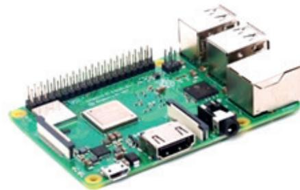
Figura 3. Minicomputadora Raspberry Pi modelo 3B+. Nota: Lopez et al. (2020).
