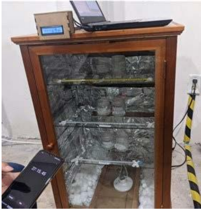
Figura 6 Desarrollo de prototipo para la germinación de semillas hortícolas.
