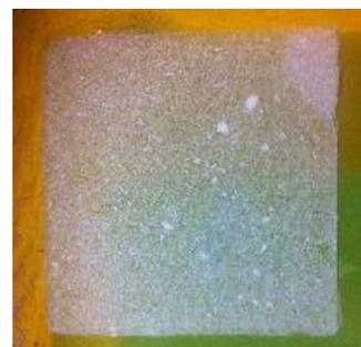
Las dimensiones de la biopelícula sin fibra fueron de 20.3 cm x 10 cm y 1.2 mm de espesor y las de la biopelícula con fibra de 15.5 cm x 15.5 cm y 1 mm de espesor (Figura 3 y 4).
