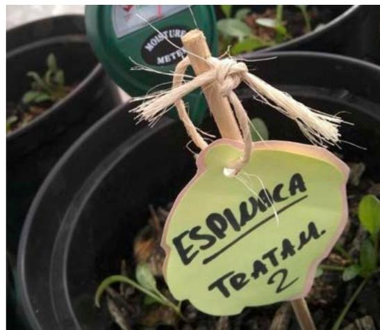
Nota: El monitoreo se llevó a cabo en los 5 tratamientos con el uso de un sensor capaz de medir la humedad del suelo en rangos de 1 a 3 para un suelo seco, de 4 a 7 para un suelo húmedo y de 8 a 10 para un suelo muy húmedo.
