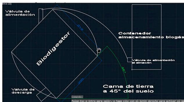
Nota. Fuente elaboración propia en AutoCAD. Se presenta el diseño general del biodigestor de bolsa, con sus respectivas medidas y el ángulo de inclinación respecto al suelo para una mayor captación de gas y sedimentación de sólidos.
